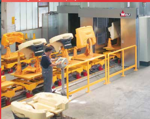
Ipari festőberendezés konvektor pályával és robotokkal, Moosburg Jungheinrich telephely
